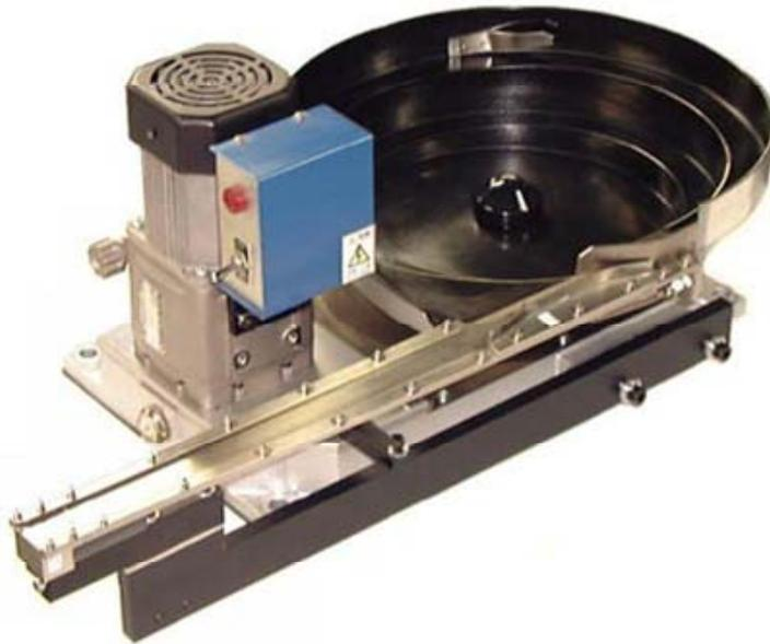
シンプルなツーリングで確実な部品の方向整列および全長にわたり均一な部品の輸送を行う直進トラフと、ボウルを一体としたもので一個のモータで駆動します。MOTRONは、バネ調整などが全く不要な純機械的振動フィーダです。
