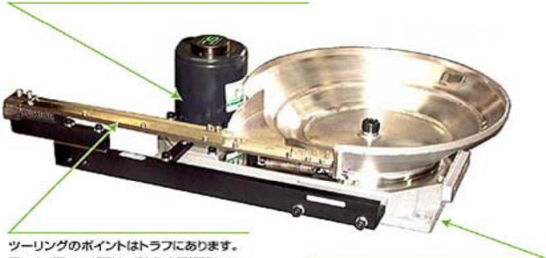
ツーリングのポイントはトラフにあります。モータ式フィーダでは、ポウル内で複雑なツーリングを行わず、トラフ上でツーリングを行います。よってワークの変更に対しては、トラフを交換するだけという従来にないシステムです。
